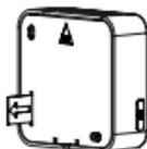
Commencez par retirer la languette au dos du capteur pour l'alimenter.
