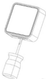
Il faut dégrafer le capot du socle avec un tournevis pour vis à fente
